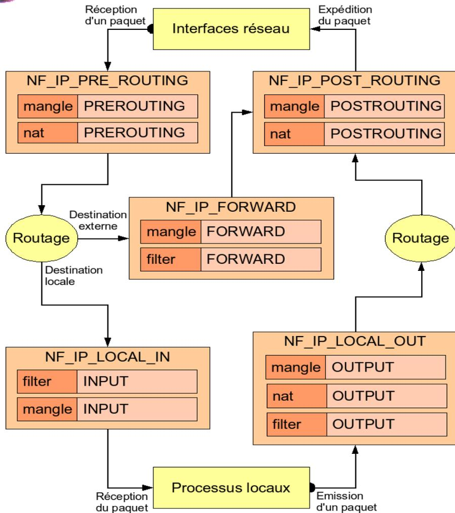
Lorsqu'un paquet arrive sur la machine où fonctionne un noyau Linux, une décision de routage est prise :
