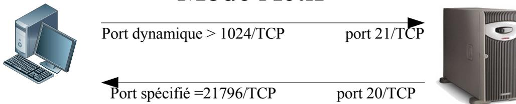
Le client FTP se connecte sur le port des commandes (21).
