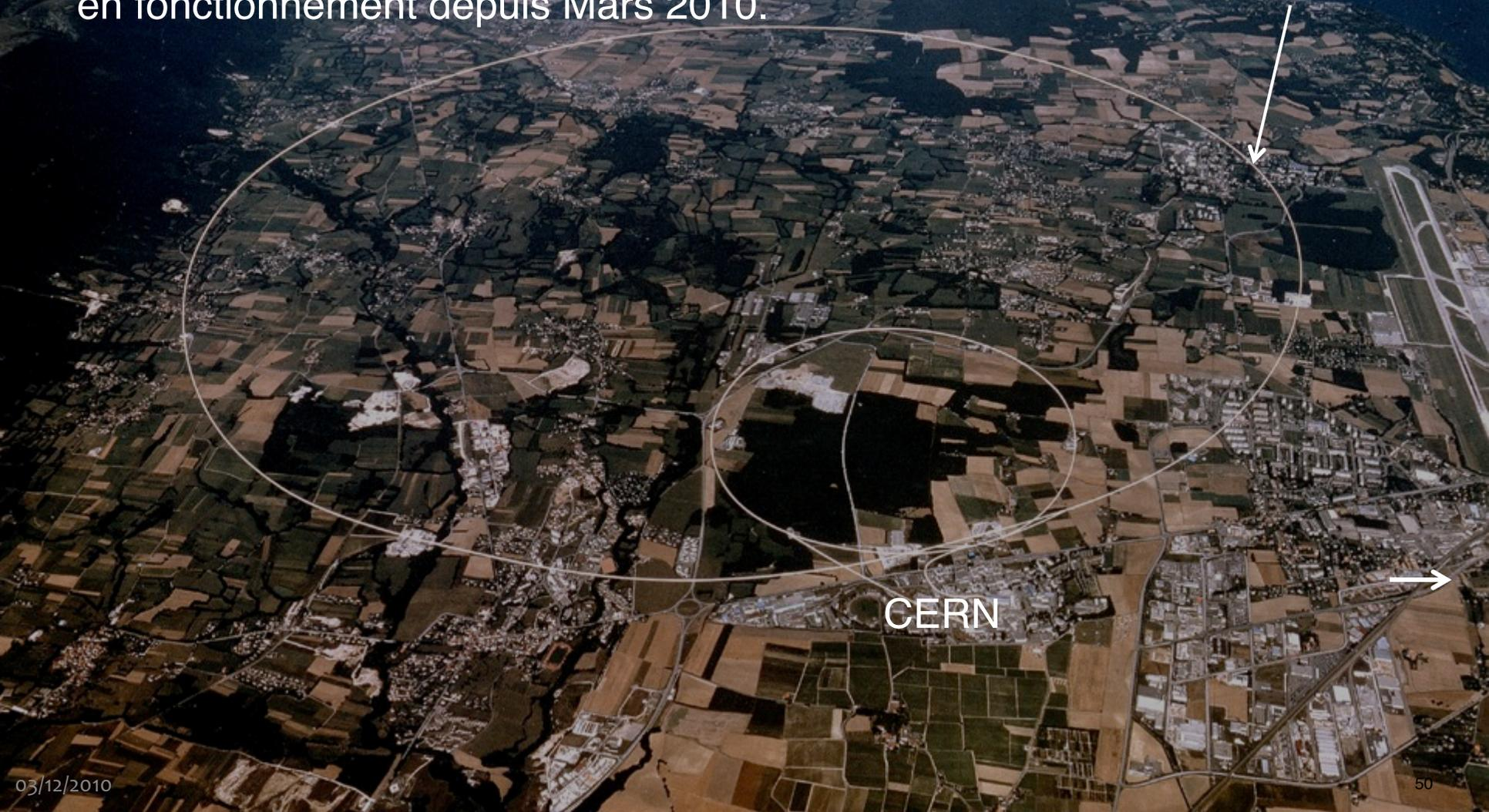
Les protons circulent en sens contraires dans 2 anneaux indépendants. Les faisceaux de protons sont amenés en collision en 4 points d'interaction où sont installés les 2 « gros » détecteurs ATLAS et CMS (+2 détecteurs spécialisés ALICE et LHCb).
