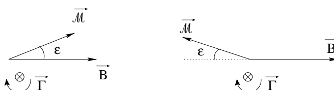
Fig. 4. Quand le moment magnétique et le champ sont de même sens, le couple exercé par \vec{B} tend à ramener le moment magnétique dans sa position d'équilibre. L'équilibre est donc stable. S'ils sont de sens opposés, une petite modification de position est amplifiée par le couple. L'équilibre est donc instable.
