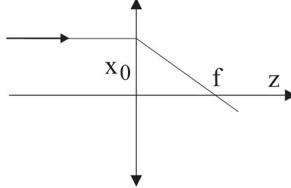
$$\begin{pmatrix} x_0 \\ \frac{-x_0}{f} \end{pmatrix} = \begin{pmatrix} x \\ x' \end{pmatrix} = \begin{pmatrix} 1 & 0 \\ -k^2\ell & 1 \end{pmatrix} \begin{pmatrix} x_0 \\ 0 \end{pmatrix}$$
