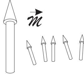
De même que nous avons décrit le dipôle électrique de l'unité de volume par  $\vec{P}(x)$ , on décrira le moment magnétique de l'unité de volume par  $\vec{M}(\vec{x})$  : le vecteur aimantation. Dans un modèle microscopique
